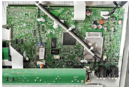
Dolna komora zawiera moduł sieciowo-strumieniowy.
